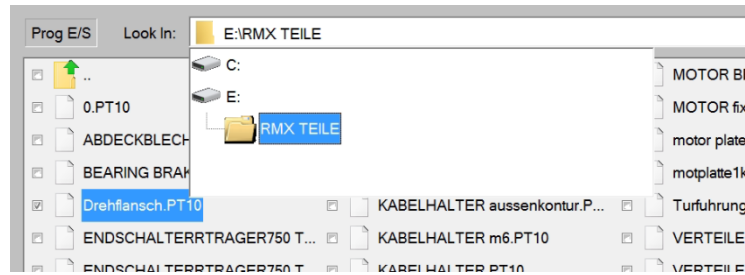
Abb. 14.1 Das Feld „Look In“ antippen, um die verfügbaren Laufwerke und der Dateipfad für das markierte Programm anzuzeigen.
