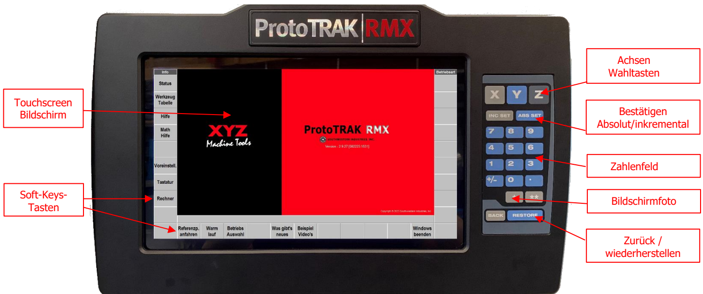
Abb. 3.3.1 Vorderseite der ProtoTRAK RMX Steuerung
