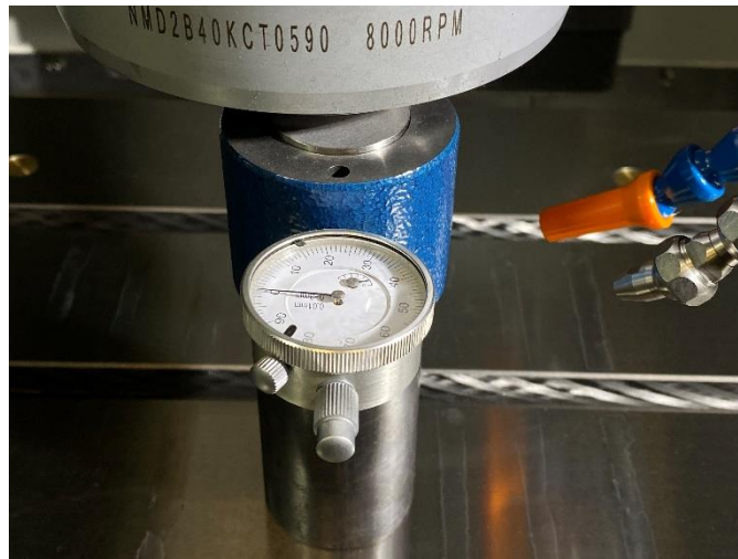
Abb. 6.2.1 (c) Basis setzen mit dem Nulleinsteller und Spindel
