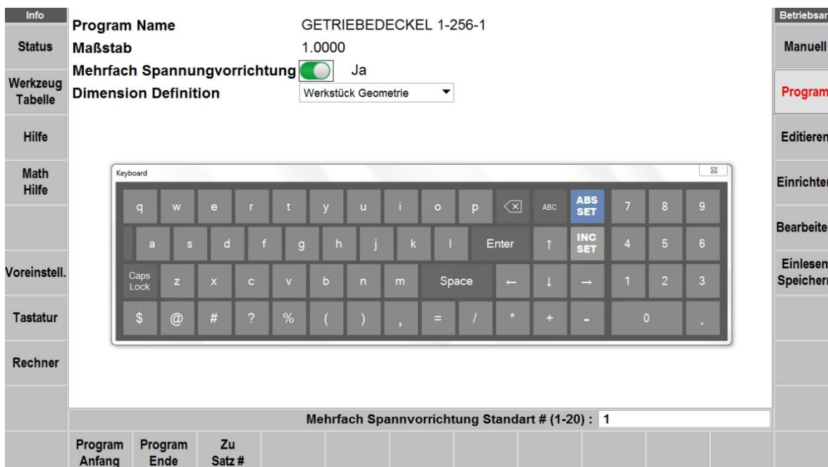
Abb. 8.3 Der Bildschirm Programm-Name mit geöffneter Tastatur zur Eingabe des Teilennamens.
